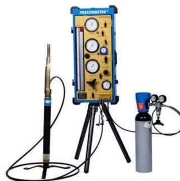
Matériel d'essai pressiométrique
